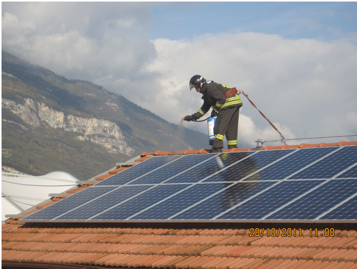
Figura 5-14: prova con PreventoSolar: inizio primo spruzzata
