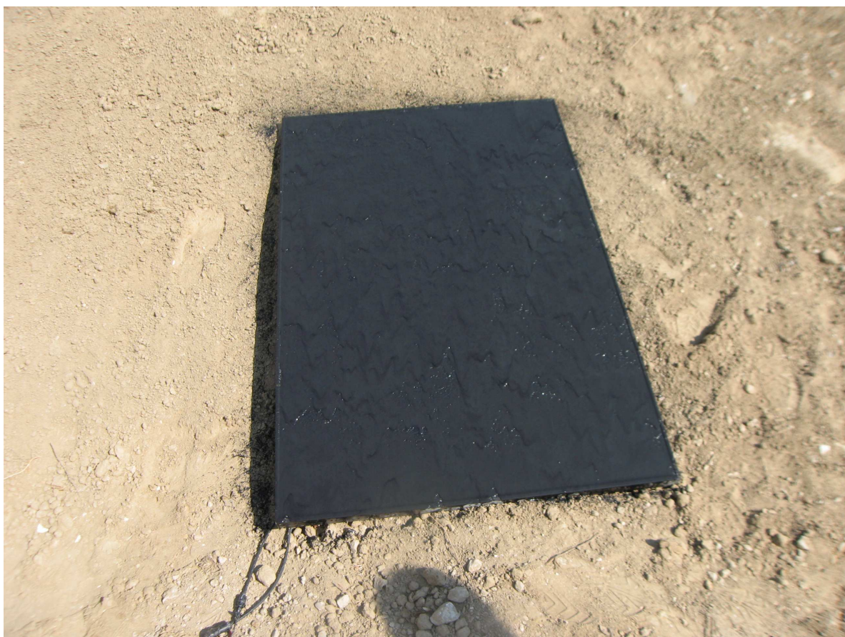
Figura 5-35: prova con gel Prevento Solar su pannello Sunpower: pannello coperto
