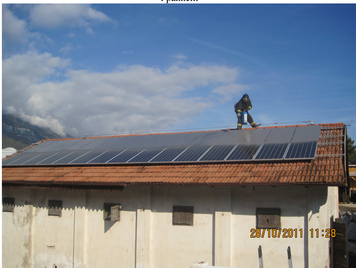
Figura 5-19: prova con Prevento Solar: fine terza spruzzata, copertura di tutti i pannelli
