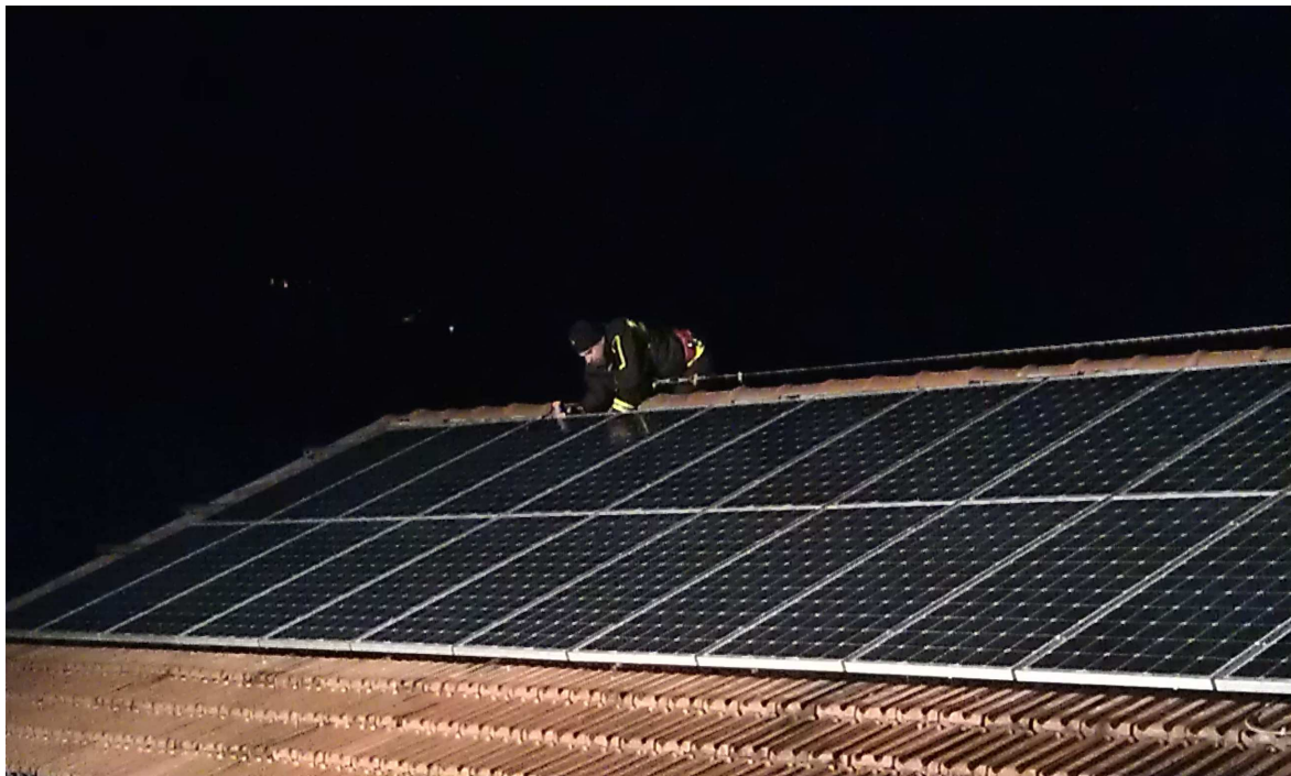
Figura 5-42: prima prova: colonna fari distante 7,5 m dalla stringa in prova, verifica della radiazione tramite solarimetro ai lati della stringa
