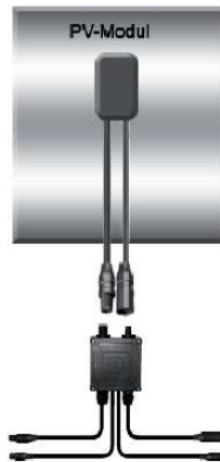
Figura 4-5: posizionamento della strumentazione BFA
