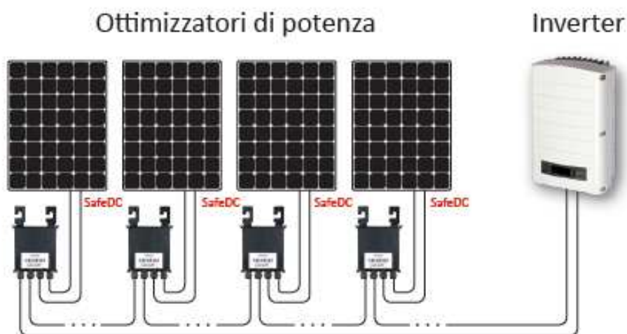
Figura 4-4: architettura del sistema SOLAREEDGE
