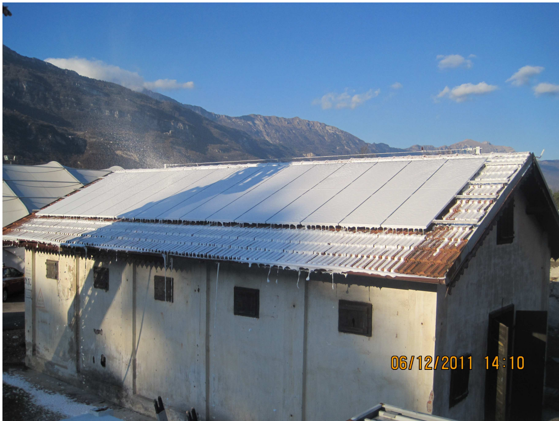
Figura 5-6: prova con CAFS: schiumaggio completato
