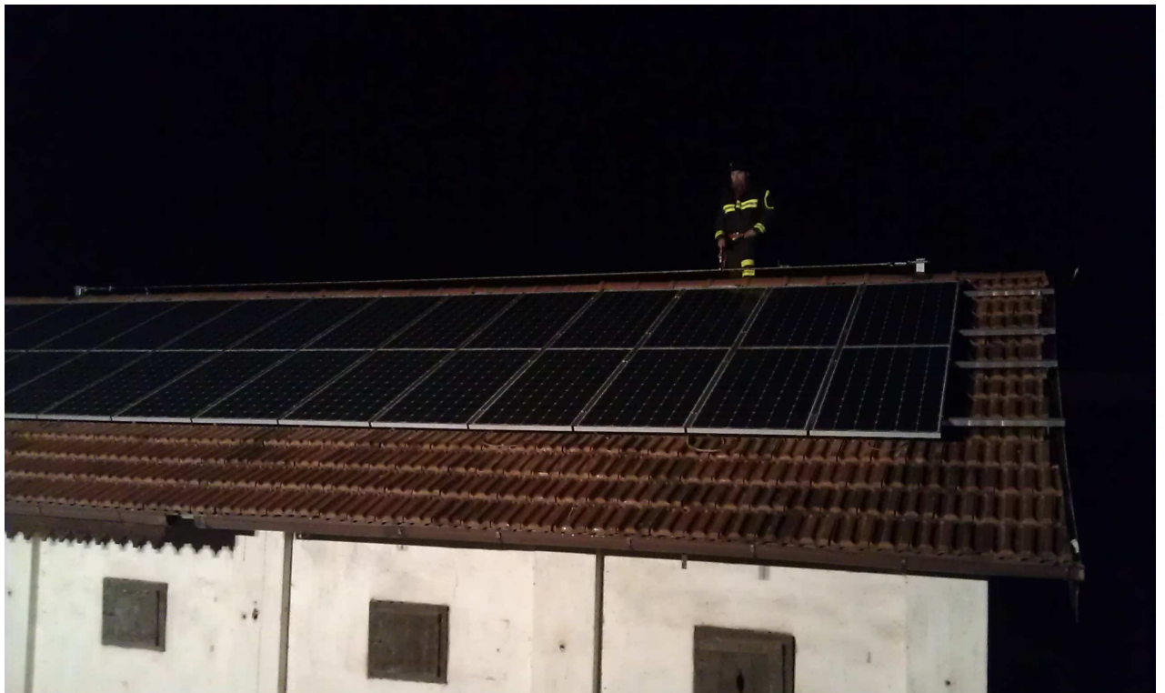
Figura 5-47: seconda prova: colonna fari distante 15 m dalla stringa in prova
