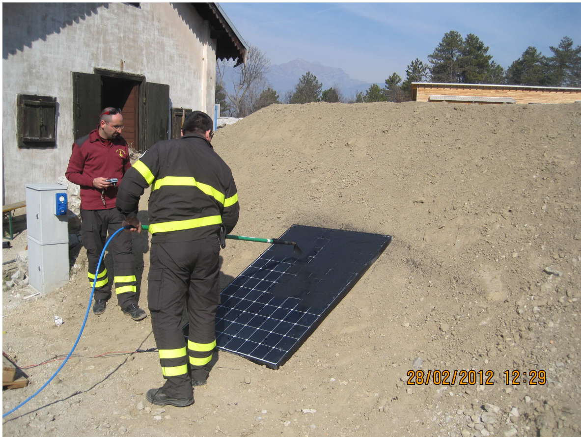
Figura 5-34: prova con gel Prevento Solar su pannello Sunpower
