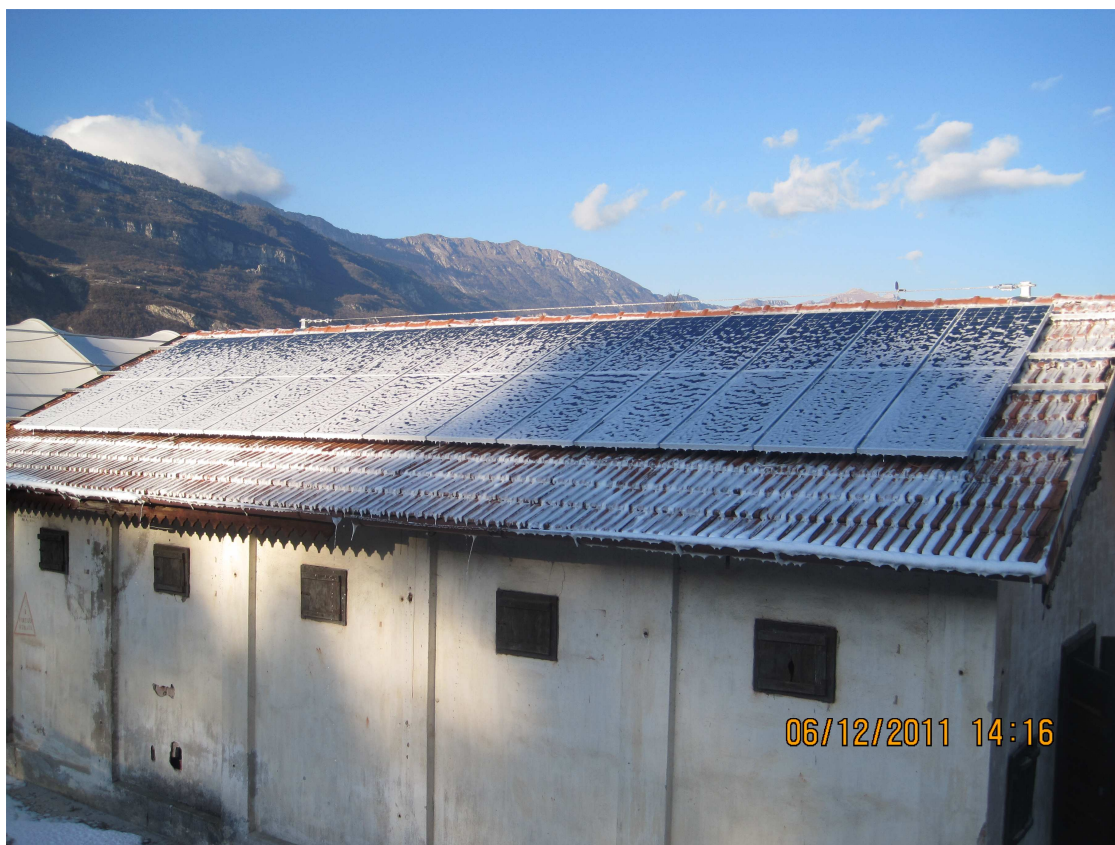
Figura 5-7: prova con CAFS: schiuma in fase di discesa
